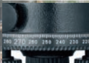
Horizontalkreis mit endlosem Seitenfeintrieb zum präzisen Anvisieren.
