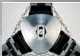
Eine umlaufende Stahlkette verhindert auf glatten Böden das Ausscheren der Stativbeine.
