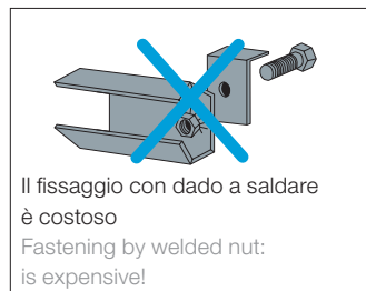
L'inserto è la soluzione migliore The best solution: threaded rivet nut
