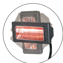
MT 22 - grille de protection chromée, réflecteur en acier inoxydable poli, émetteur orientable, angle maxi 45°
