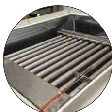
Échangeur de chaleur
