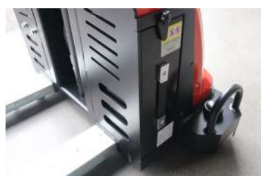
Accès à la batterie via trappe latérale
