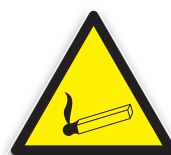
Danger flamme nue matière inflammable
