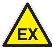
Danger atmosphère explosive
